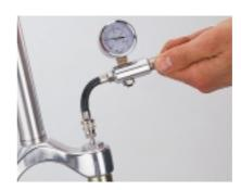
soviel Gabelöl oder Rock Shox Red Rum, dass der Luftkolben komplett mit Flüssigkeit bedeckt ist. Sodann werden die Luftkappen mit gefettetem O-Ring wieder eingeschraubt und mit 6 Nm angezogen. Dann befüllen Sie die Luftkammern wieder mit dem gewünschten Druck.
