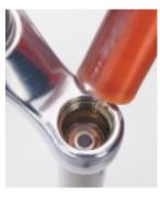
Den ZUSAMMEN-BAU beginnen Sie in umgekehrter Reihenfolge. Also zuerst wieder die beiden Schäfte mit den eingeölten Luftkolben voran ganz in die innen ebenfalls mit Öl benetzten Standrohre schie-
